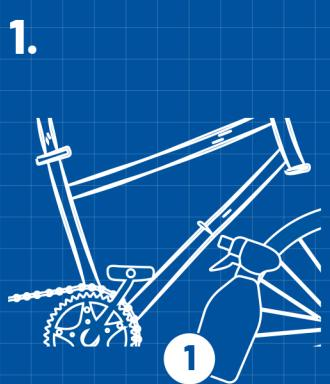
向腳踏車噴水以清除任何大塊塵土或污垢。接著在腳踏車噴灑 WD-40 Specialist Bike Cleaner (WD-40 專業系列。多功能清潔劑)，以乾淨抹布擦拭清除任何塵土及污垢，徹底清潔腳踏車。
