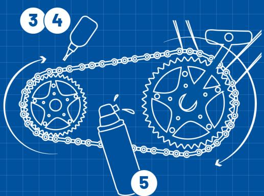
您可選擇 WD-40 一系列的 Bike Chain Lube (全效型鍊條潤滑劑) 產品潤滑鍊條。轉動腳踏車踏板讓鍊條跟著轉動，並以精準噴嘴直接噴灑在整條鍊條上。讓潤滑油滲入鍊條，並擦拭清除多餘潤滑油避免積聚。
